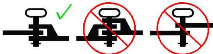
**FIGURE 2-1. Hitch Connection**
