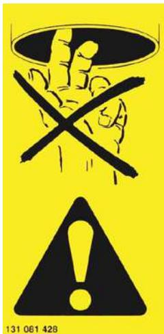
Ne jamais mettre les mains à la sortie de la vis de fond quand le nettoyeur est en fonctionnement.
